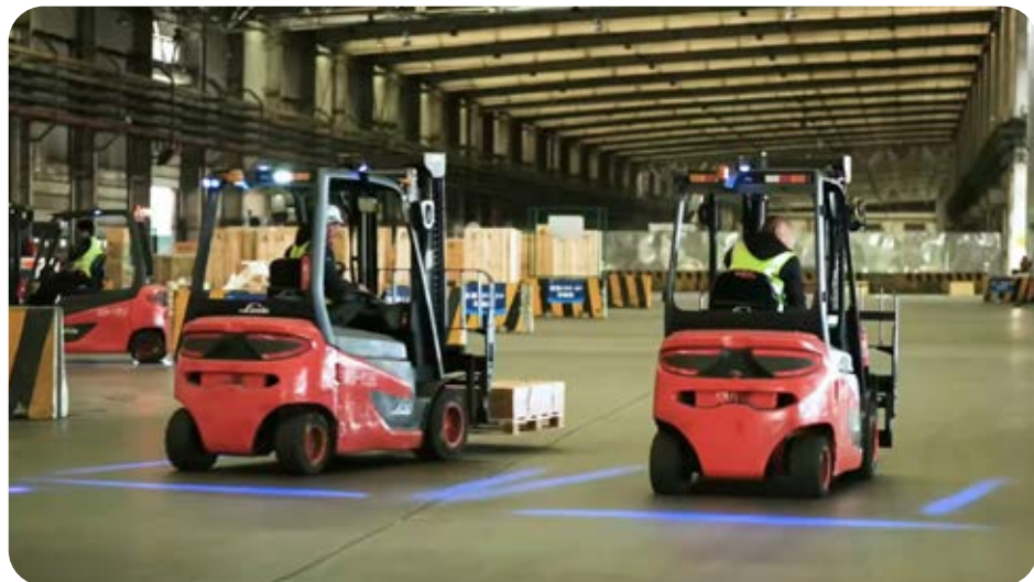
“叉车加装警示灯带”方案：以光束投影在地上的形式，在叉车周围形成显著边界，方便提醒周边人员、叉车本身及其他叉车主动及时避让
