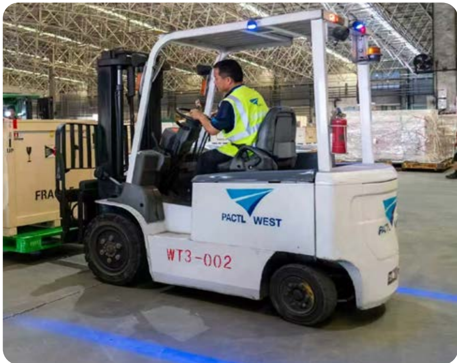
“叉车加装警示灯带”方案：以光束投影在地上的形式，在叉车周围形成显著边界，方便提醒周边人员、叉车本身及其他叉车主动及时避让
